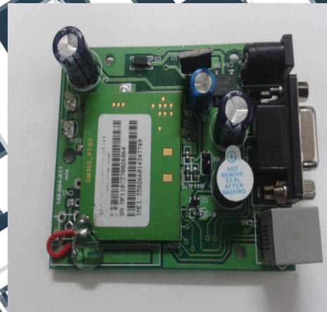
**Fig. 4 GSM module**
