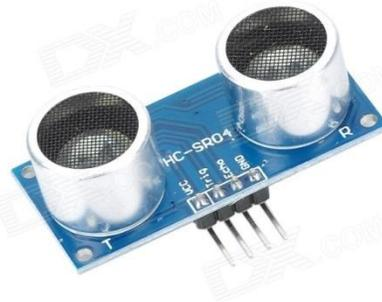
Fig. 3: ultrasonic sensor module
